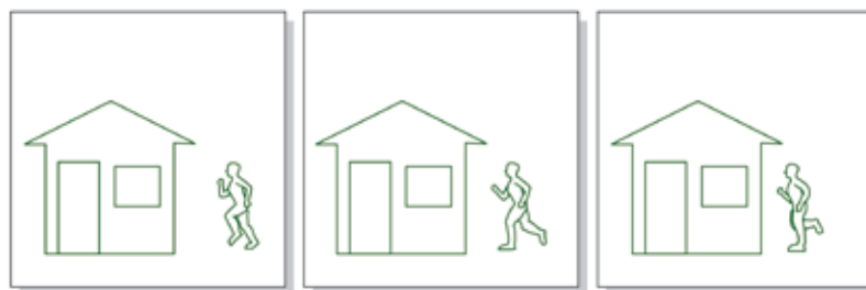
Abbildung 3. Im Motion JPEG-Format werden die drei Bilder in der obigen Folge codiert und als separate, eindeutige Bilder (I-Frames) übertragen, die voneinander unabhängig sind.
