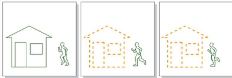
Abbildung 4. Bei der Differenzcodierung (in den meisten Videokomprimierungsstandards einschließlich H.264 gebräuchlich) wird nur das erste Bild (I-Frame) vollständig codiert. In den beiden folgenden Bildern (P-Frames) wird bei den statischen Bestandteilen, in diesem Fall das Haus, nur auf das erste Bild verwiesen. Nur die bewegten Bestandteile, hier der Läufer, werden mit den Bewegungsvektoren codiert. Dadurch wird die gesendete und gespeicherte Datenmenge verringert.
